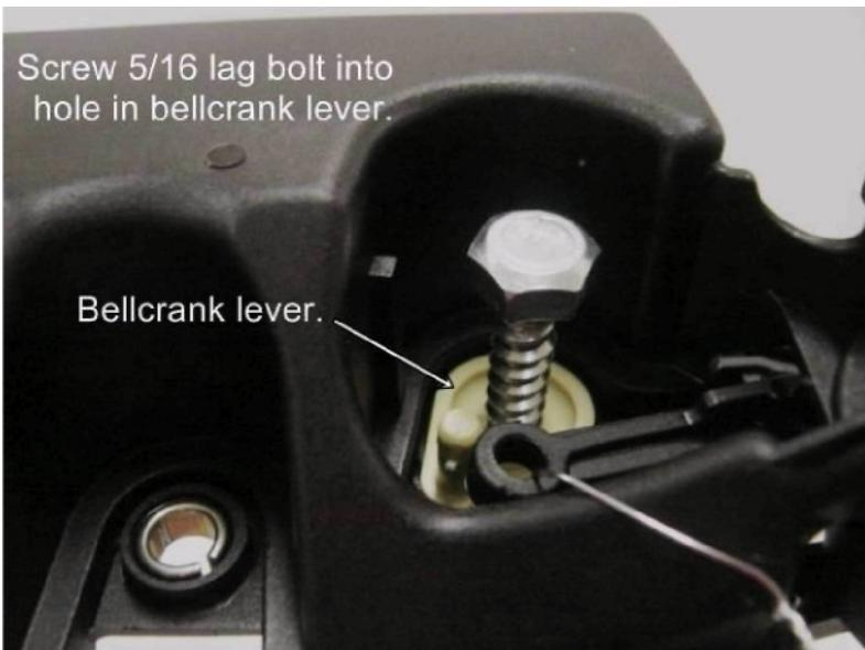
Извлеките коленчатый рычаг, для этого можно использовать подходящий шуруп.
