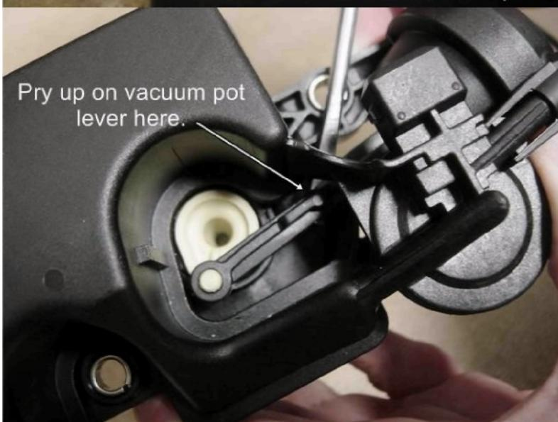
После удаления фиксирующей шайбы, отсоедините привод вакуумного клапана от коленчатого рычага, поддев его отверткой.
