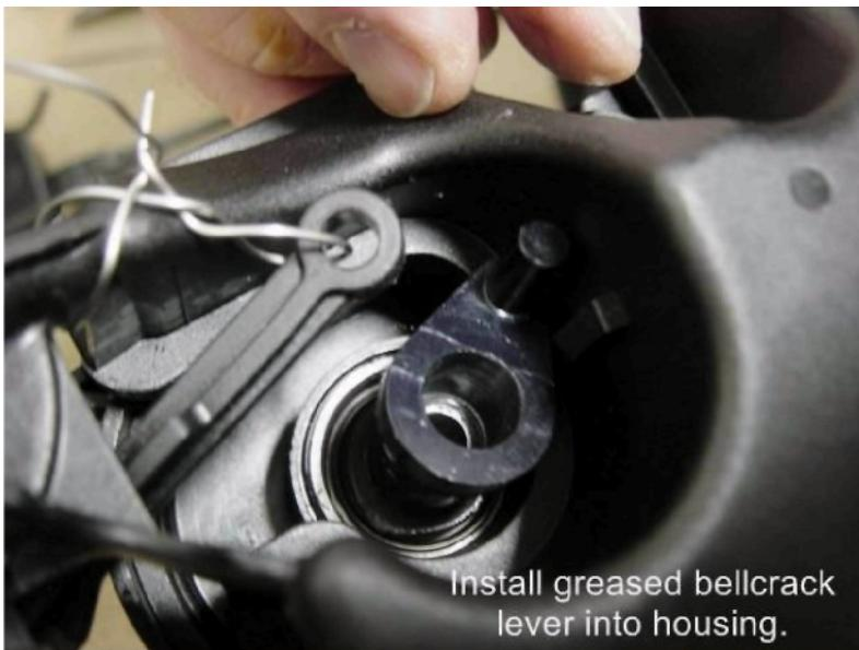
Положение коленчатого рычага при установке.
