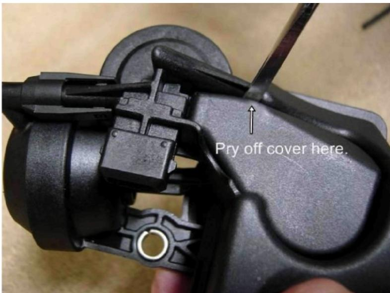
Установка начинается с удаления крышки привода. Используйте маленькую плоскую отвертку.
