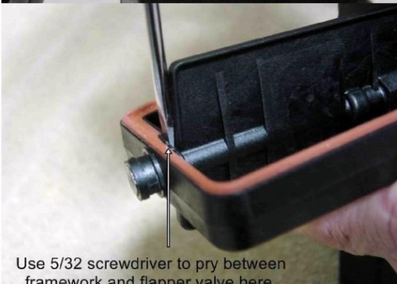
Удалите верхний направляющий штифт. Он сидит достаточно глубоко на одном уровне с рамой. Для его снятия можно вставить отвертку между лопастью и рамой, слегка приподняв раму (следите за тем чтобы не повредить раму, чрезмерные усилия не допустимы). После снятия нагрузки штифт приподнимется над поверхностью рамы и его можно будет удалить.
